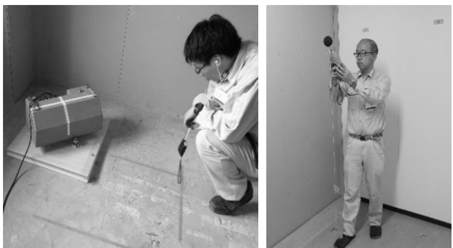
図3 (左) 加振風景と (右) 受音風景
