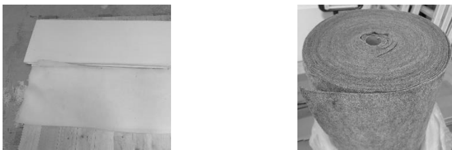
図4 SSボード（左:SSボード5mm厚 右:SSボード3mm厚）
